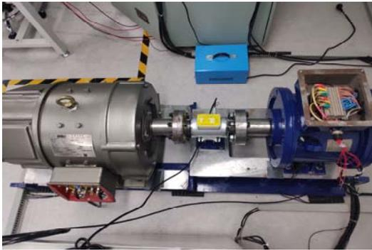
图8 9kW 九相永磁电机机组
