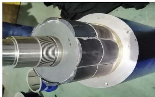
图 7 偏心削极永磁转子
